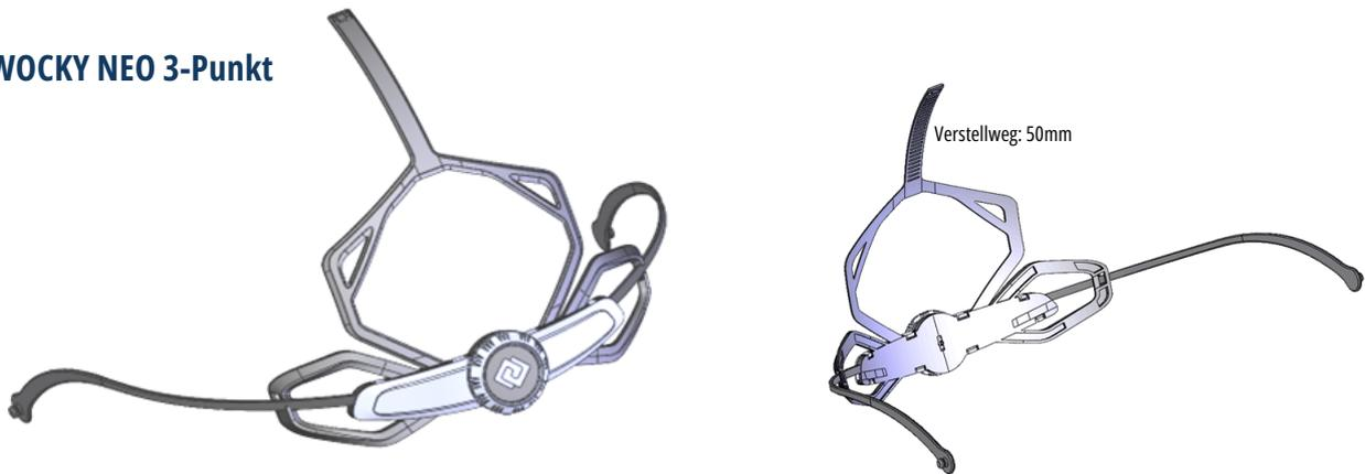
Die 3-Punkt-Ausführung wird an zwei Haltepunkten seitlich im Helm eingeklickt. Ein Rasterband an der Kopfspinne, verbunden mit einem Anker im EPS, ermöglicht eine individuelle Höhenverstellung, sodass die Kopfspinne optimal an die Kopfform angepasst werden kann.
